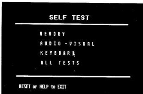
Wählen Sie mit der SELECT-Taste die gewünschte Prüfung und drücken Sie dann auf die START-Taste. Ein Druck auf die HELP-Taste führt zum SELF-TEST-Menü zurück. Mit der RESET-Taste kann der gesamte Test unterbrochen und zum ATARI BASIC zurückgekehrt werden.
